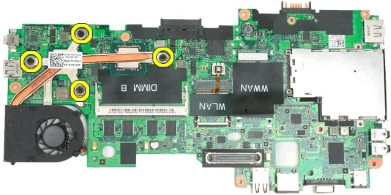
61. הסר את החלק העליון של מכלול גוף המונע חימום מלוח המערכת, ולאחר מכן הפוך את לוח המערכת שנית.
