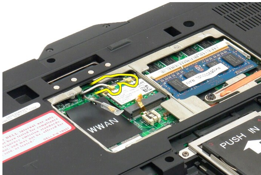
5. השתמש באצבעותיך כדי לשחרר בעדינות את המהדקים ולשחרר את ה-mini-card.
