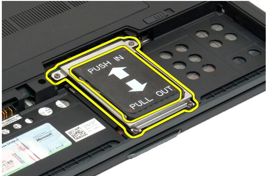
5. החלק את הכונן הקשיח לכיוון קצה מחשב הליח כדי להתנתק מלוח המערכת.
