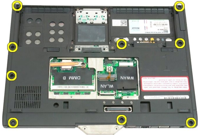
8. הפוך את מחשב הלוח והסר את שלושת הברגים המאבטחים את משענת כף היד לחלקו העליון של מחשב הלוח.
