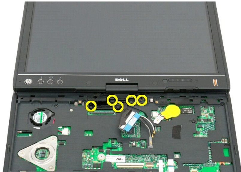
11. הרם את מכלול התצוגה כדי להפריד ממחשב הלוח.
