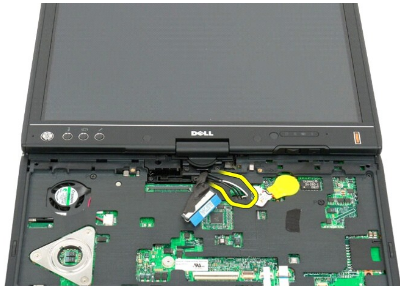
01. הסר את חמשת הברגים המחברים את מכלול התצוגה למחשב הלוח.
